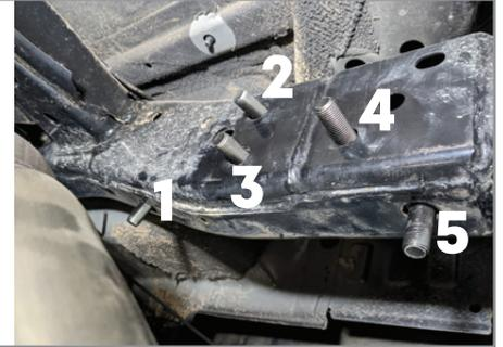
**ШАГ 2.** Прикрутите кронштейн к левому лонжерону штатными метизами. Прикрутите кронштейн к шпилькам закладных в правом лонжероне гайками M12 x1,25 с фланцем.
