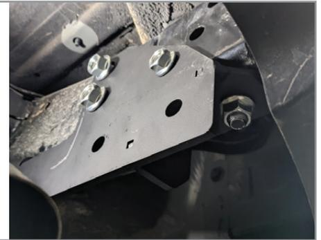
**ШАГ 3.** Установите балку, закрепив её на кронштейнах болтами M12x1,25x45 через шайбы 12 и гроверные шайбы 12, закрепив их гайками M12 x1,25 с фланцем. Демонтируйте штатные метизы крепления заднего бампера к усилителю бампера, заменив их болтами М6, с шайбами увеличенными 6 и гроверными шайбами 6 из комплекта поставки.
